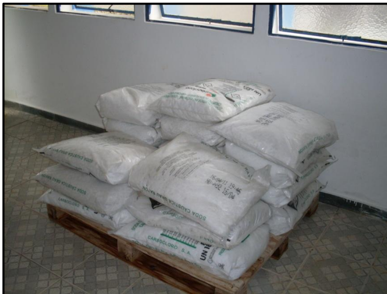
Foto 06: Sacos de hidróxido de Sódio dispostos em contato com a parede e sem divisão por lotes ou data de vencimento.
