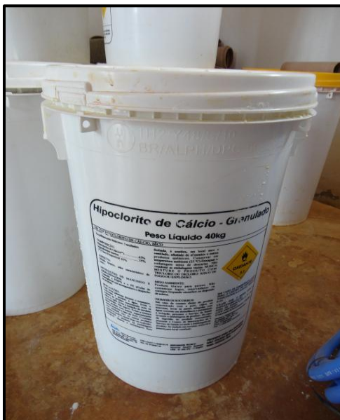
Foto 11: Solução de Sulfato de Alumínio estocada em bombona de hipoclorito de Cálcio
