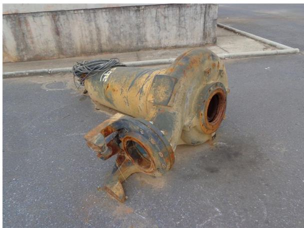
Foto 1. Conjunto motobomba danificado (C1.1)
