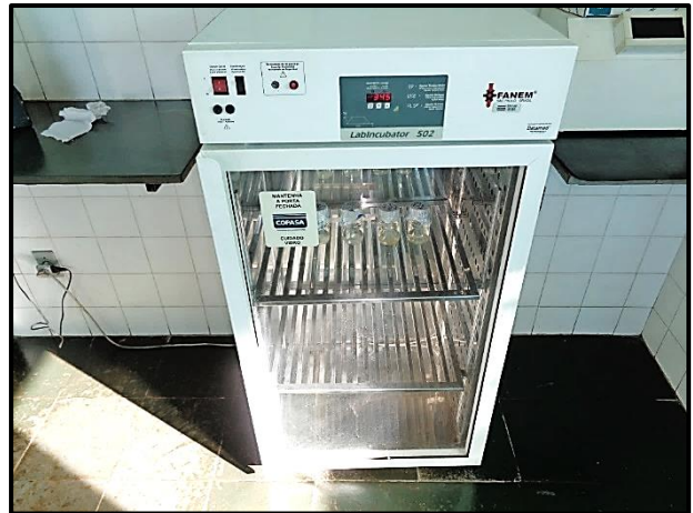
Imagem 4. Estufa microbiológica sujeita à radiação solar.
