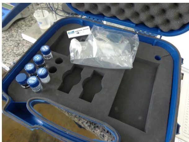
Foto 9. Padrão de calibração para turbidímetro sem data de validade ou data de aferição.
