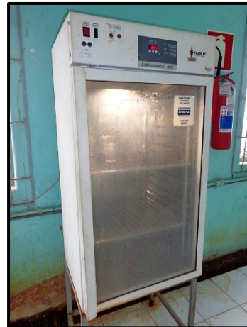
Imagem 4. Vidro da porta da estufa afetado pelos gases da casa de química.
