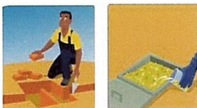
Construa caixa de gordura (caixa sifonada) nas instalações de esgoto e faça limpeza periódica da gordura retida. Isso, além de impedir entupimentos, evita o aparecimento de insetos, como moscas e baratas.
